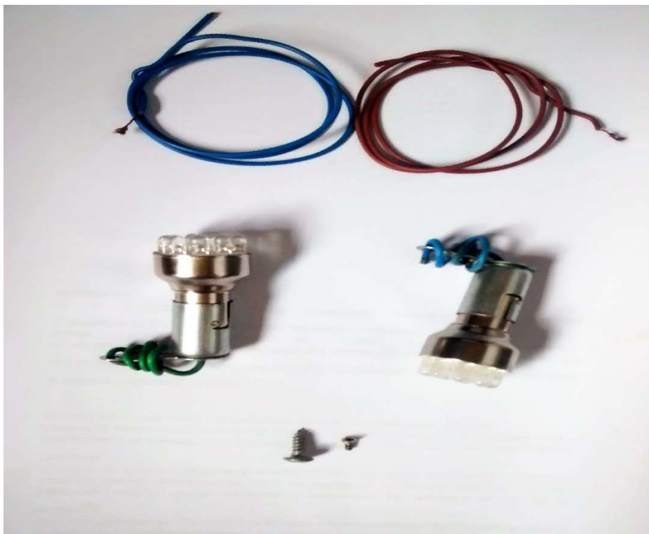
FIGURA 7 – Soquetes para lâmpada 1141 com haste, parafusos, lâmpadas e fios.
