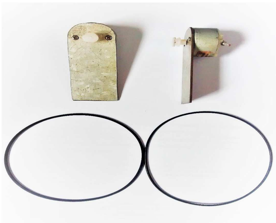
FIGURA 8 – Chapa de aço inox, motores DC 12V, parafusos e anéis de vedação.
